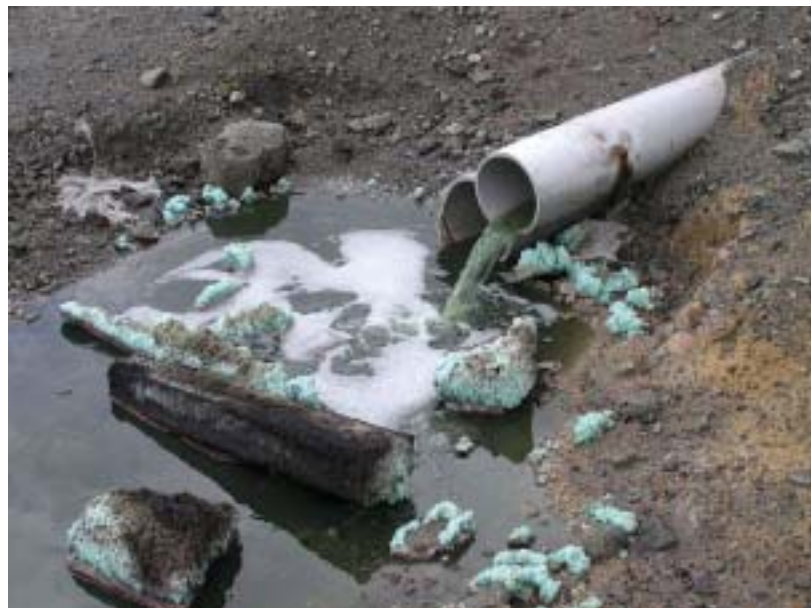
Fig 2b: Aguas ácidas de un botadero de pirita con pH 1.5. El pH es demasiado bajo para que las bacterias puedan oxidar efectivamente el ferroso al férrico. Es la razón que no se observa la precipitación de los hidróxidos férricos. Los precipitados azules/celestes son sulfatos de cobre.
