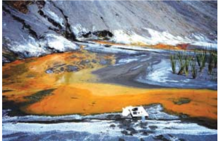
Fig 2a: Aguas ácidas en el pie de un depósito de relaves con pH 3 con la precipitación de schwertmannita y goethita. Los precipitados blancos son de yeso.
